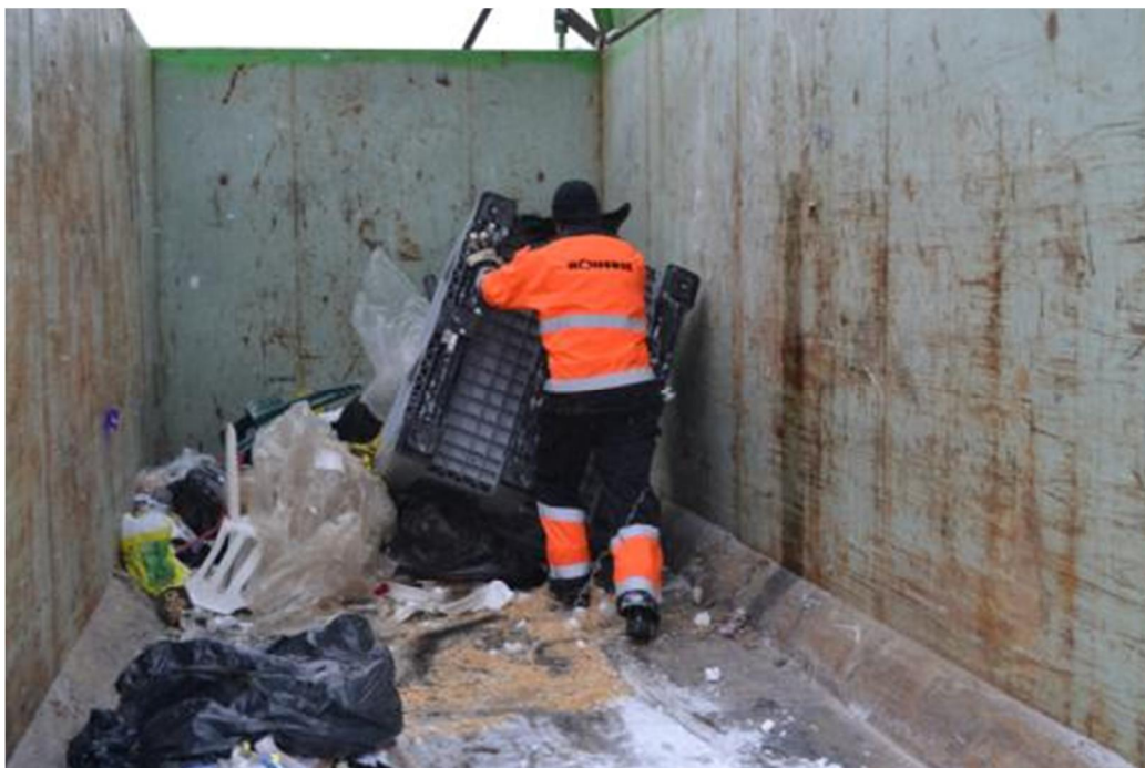
Kuva 6.8. Jäteasemien energiajätteen osanäytteen kippaus siirtolavalle varastointia varten.
