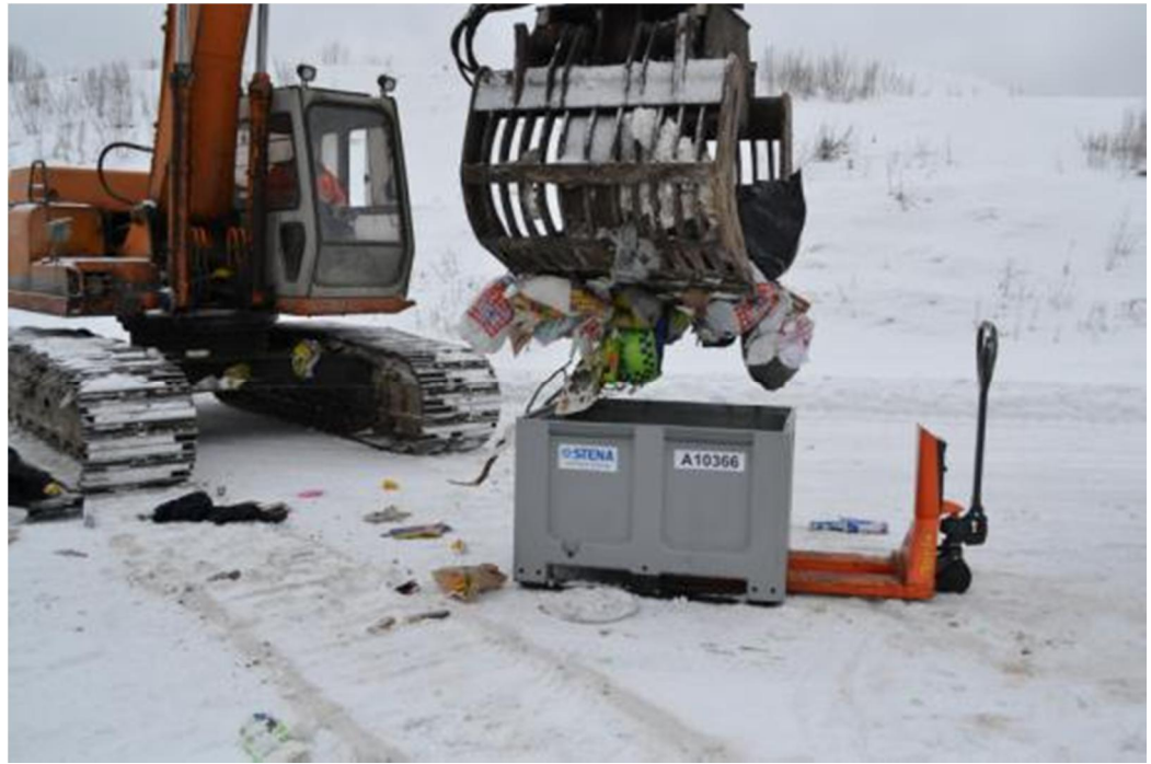
Kuva 6.6. Kiinteistöjen erilliskerättyä energiajätettä pudotetaan punnituslaatikkoon.
